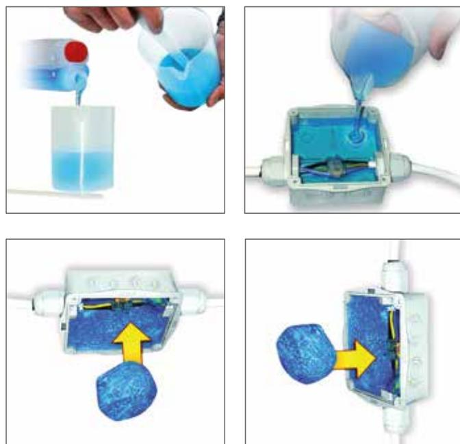
Es posible utilizar el Gel Aislante **Magic Power** suministrado en la botella bicomponente en una proporción 1:1, simplemente vertiéndolo una vez mezclado hasta cubrir las conexiones o dejar reticular la mezcla a parte, para utilizarla posteriormente a base de pegar con trozos del material hasta proteger totalmente la conexión. Gracias a sus cualidades de adherencia y flexibilidad podemos reaccionar en cualquier momento a la instalación y reutilizar de nuevo el mismo material.
