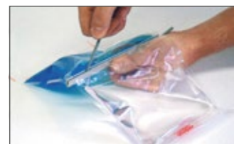
1.- Retirar la barrera entre los dos componentes
