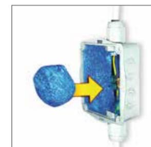
Es posible utilizar el Gel Aislante **Magic Power** suministrado en la botella bicomponente en una proporción 1:1, simplemente vertiéndolo una vez mezclado hasta cubrir las conexiones o dejar reticular la mezcla a parte, para utilizarla posteriormente a base de pegar con trozos del material hasta proteger totalmente la conexión. Gracias a sus cualidades de adherencia y flexibilidad podemos reaccionar en cualquier momento a la instalación y reutilizar de nuevo el mismo material.
