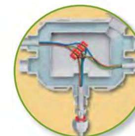
Conexión con bornes mediante tornillo Allen
