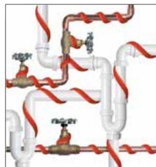
**Cable calefactor para la protección de instalaciones Stop Ice**, un innovador kit premontado formado por un cable calefactor de potencia constante de 12W/m con termostato de contacto instalado en un extremo del cable y base de toma de enchufe en el extremo opuesto.
