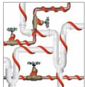
**Cable calefactor para la protección de instalaciones Stop Ice**, un innovador kit premontado formado por un cable calefactor de potencia constante de 12W/m con termostato de contacto instalado en un extremo del cable y base de toma de enchufe en el extremo opuesto.
